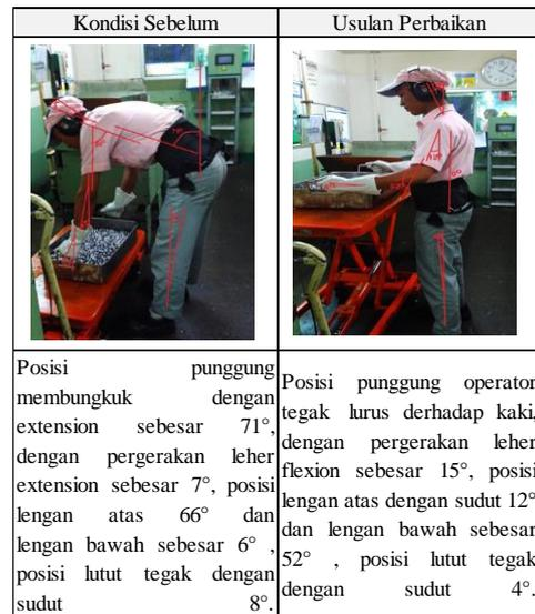
Gambar 4.13. 1. Usulan Perbaikan Stasiun Operator Vibrator
