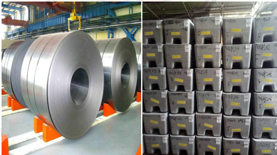
Gambar 1.1 Bahan baku CRC dan Zinc pembuatan galvanized steel
