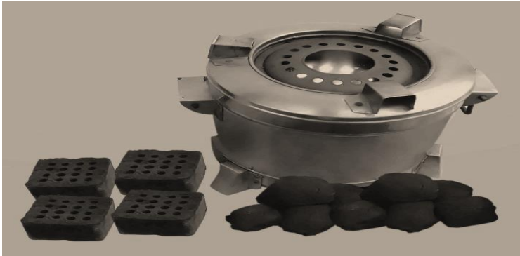
Gambar 5. Briket sebagai bahan bakar padat (dari limbah kertas dan daun disekolah)
