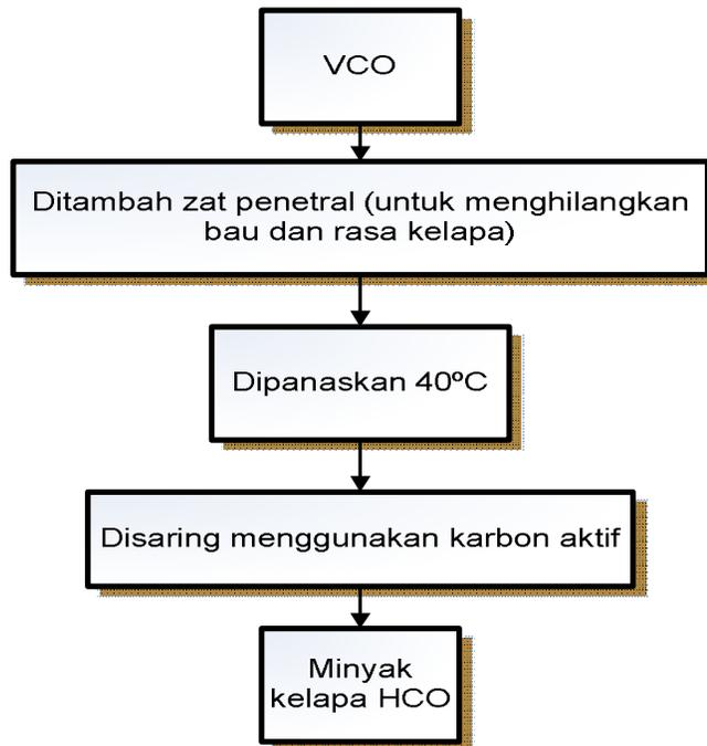
Gambar 4.5 Diagram Alir Proses Pembuatan Minyak Kelapa HCO dari VCO
