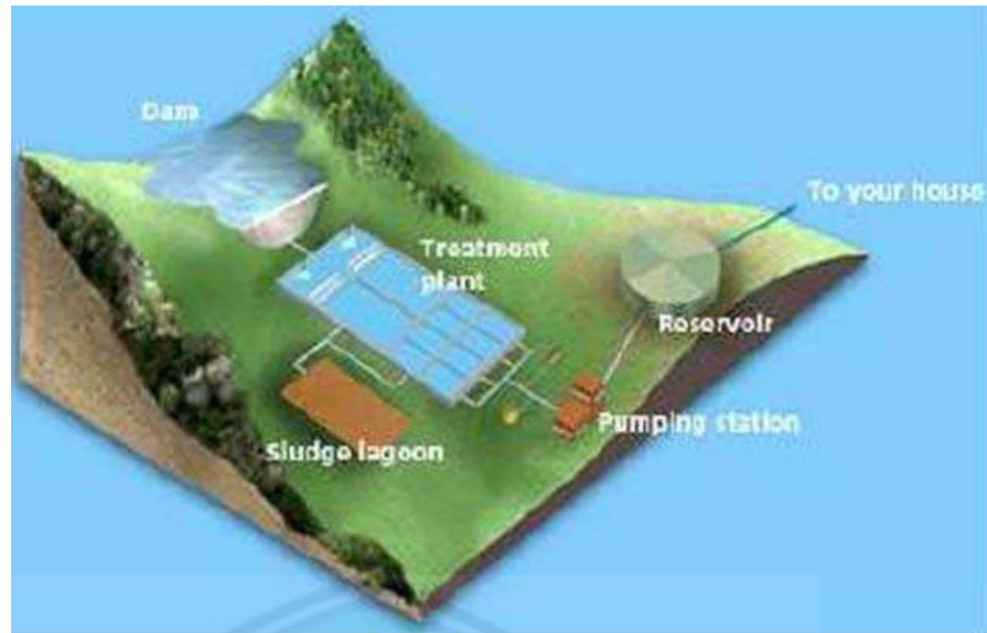
Gambar 1.2 Skema Pengelolaan Air Bersih (Instalasi Pengelolaan Air Bersih,2018)
