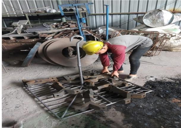
Gambar 1.2. Proses Penempatan Produk Keatas *Hanger Bucket*
