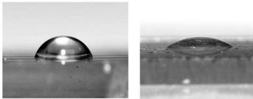
Gambar 2. 6 Pengukuran sudut kontak dilakukan pada permukaan BDD terminasi H dan terminasi O (Macpherson et al. , 2015).
