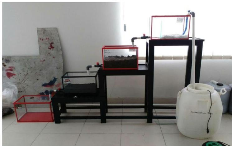
Gambar 2. Prototype alat pengolah air lindi
