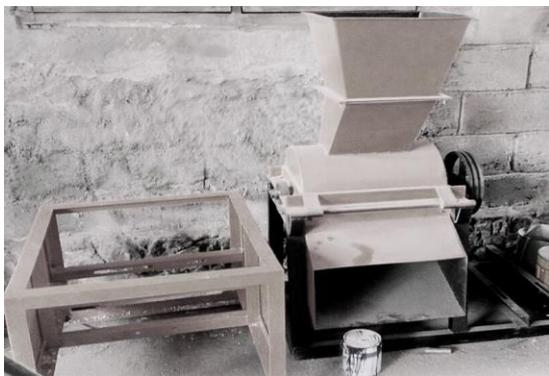
Gambar 5. Gambar mesin pengolah limbah sekam yang dibuat
