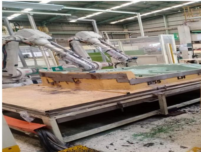
Gambar 1. 1 Mesin Waterjet
