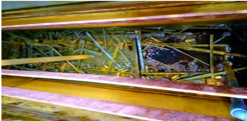
Gambar 1.1 Endapan Lumpur Chemical Pada Saat Pengurasan (Sumber: PT XYZ)
