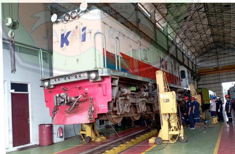
Gambar 1. 2. Penggunaan Mesin Dongkrak pada Lokomotif Sumber: KAI (2022)
