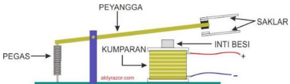
Gambar 1.13 Komponen pembentuk relay
