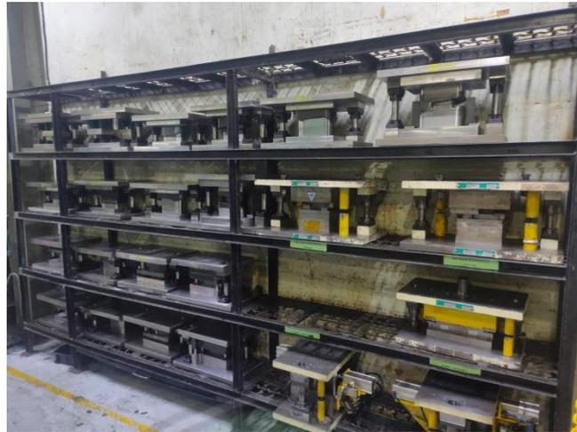
**Gambar 4. 2 Dies untuk Proses Notching**
