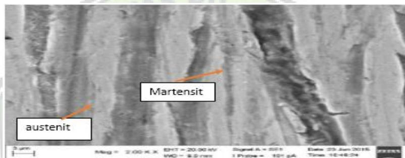
**Gambar 7.** Struktur Mikro Sampel yang Dipanaskan Pada Temperatur *Heat Treatment* 350° C dan Didinginkan pada Media Pendingin Air dengan Perbesaran 2000 kali
